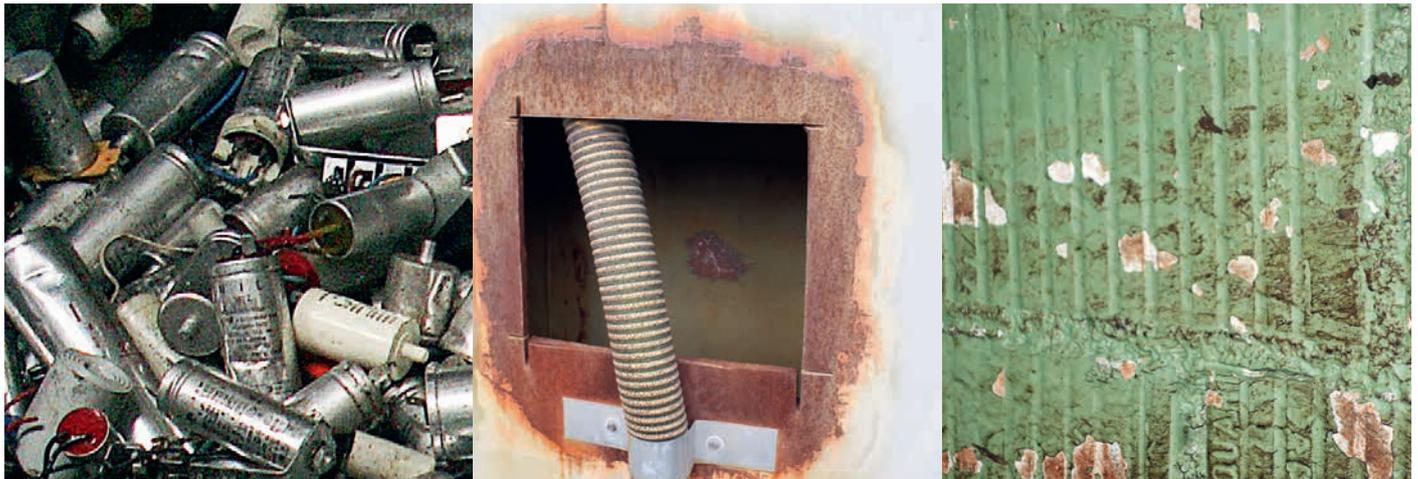
Beispiele von PCB-haltigen Kondensatoren, Korrosionsschutzmitteln und PCB-haltiger Farbe. (Fotos: EMPA)
